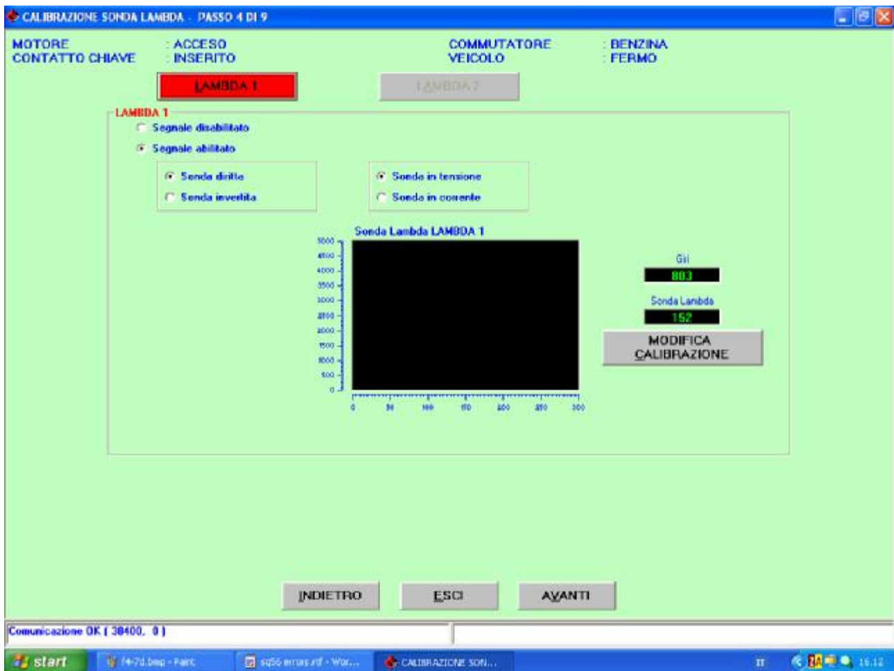
Rys. 4.8 Procedura dedykowana krok po kroku Regulacja Sondy Lambda
