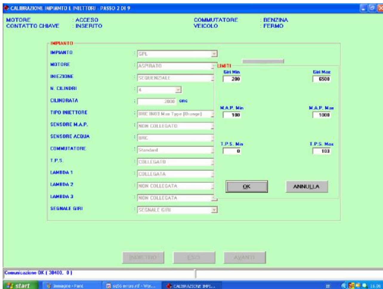
Rys. 4.5. Procedura dedykowana - regulacja instalacji i wtryskiwaczy przy pomocy przycisku INNY przy danych dotyczących instalacji.
