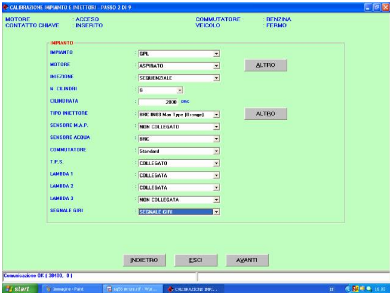
Rys. 4.4. Procedura dedykowana - Ustawianie instalacji i wtryskiwaczy
