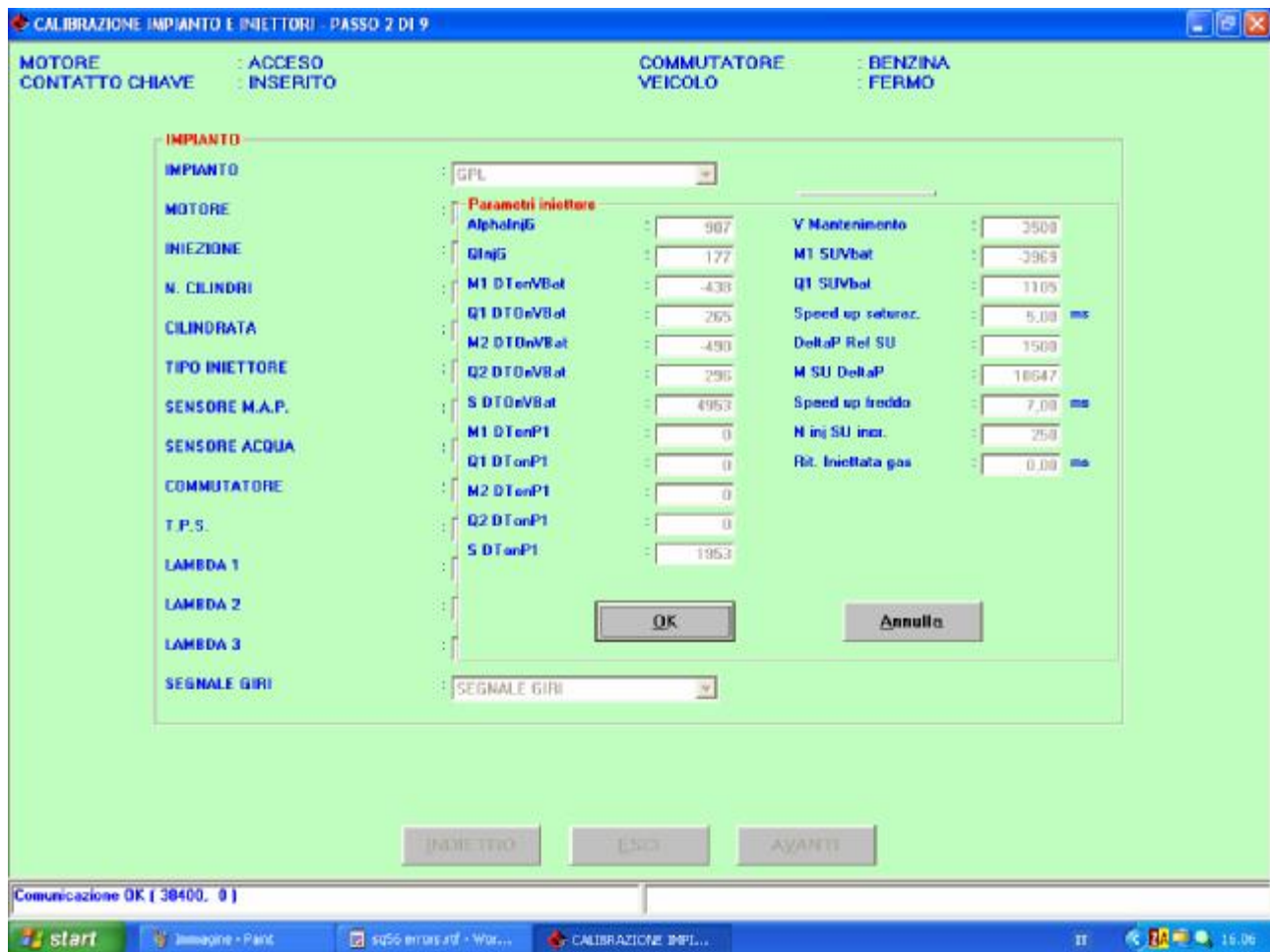
Rys. 4.6. Procedura dedykowana - regulacja instalacji i wtryskiwaczy przy pomocy przycisku INNY przy danych dotyczących instalacji.
