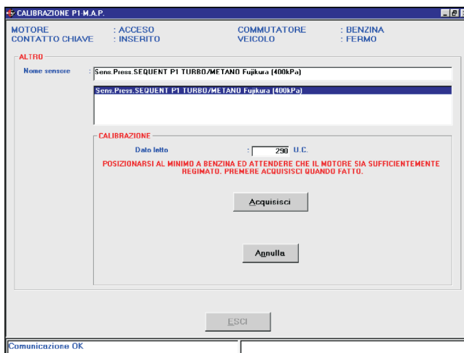
Rys. 5.14 Ustawienia - regulacja M.A.P. przy pomocy manometru zewnętrznego, zapamiętanie drugiej wartości
