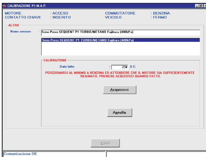
Rys. 5.11 Ustawienia - regulacja M.A.P. przy pomocy P1, zapamiętanie drugiej wartości
