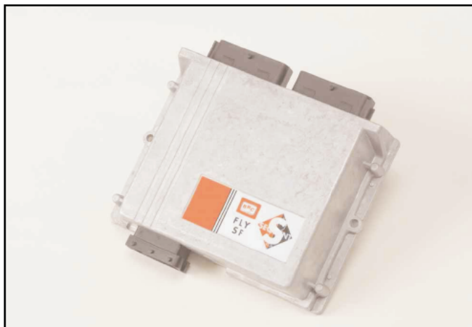
Rys. 21 Centrala "FLY SF" z podwójnym podpięciem
