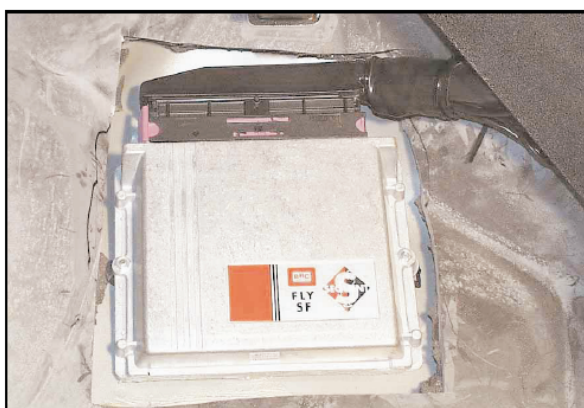
Rys. 42 Montowanie centralki w kabinie kierowcy
