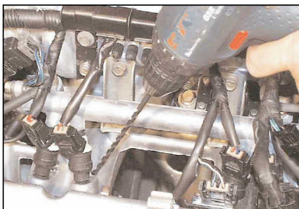
Rys. 37 Wiercenie otworów w kolektorze
