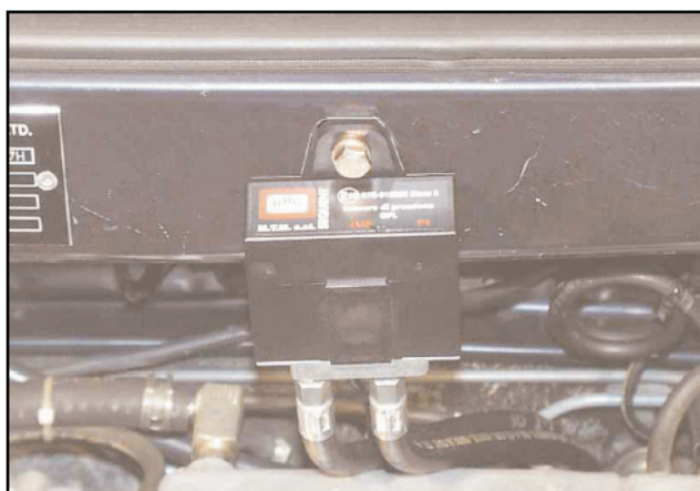
Rys. 32 Przykład zamontowania czujnika P1-MAP
